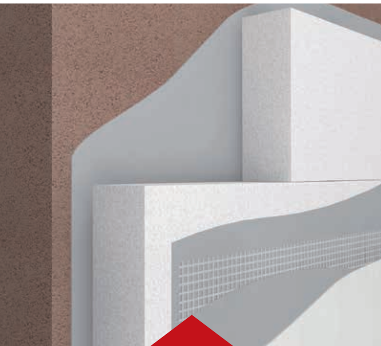
Energiesparwand mit Außendämmung
